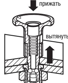
Для извлечения: нажатием кнопки вытяните стопорный шариковый палец из установочной втулки.
