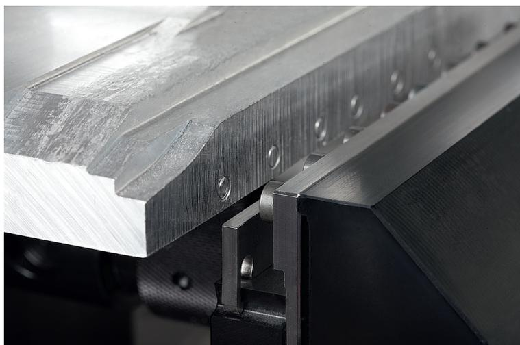
Система тисочного типа модели compact для 5-ти осевой обработки может быть компактно собрана из двух элементов, под углом 90 гр. между собой. Данная конструкция позволяет закреплять крупногабаритные детали и настраивать систему в зависимости от длин каждой из 4-х сторон детали.
