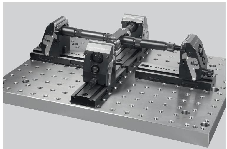
Система тисочного типа модели compact установлен непосредственно на столе машины. Использование подвижного кулачка, который дополнительно может выступать также в роли фиксирующего кулачка. Зажим обрабатываемой детали с помощью гладких кулачков.
